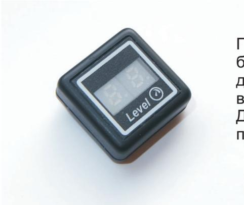
Поступило в продажу устройство индикации уровня газа в баллоне. Показания основываются на работе программного датчика газового компьютера системы TE-GAS. Индикация выводится на цифровой дисплей в виде чисел от 99 до 0. Дисплей подключается параллельно одноцветными проводами к установленному переключателю (кнопке).
