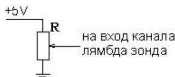
Для его питания удобно использовать напряжение +5В, снимаемое с питания кнопки управления. Это для TE-STREAM. Тогда в программе управления будут видны соответствующие изменения. В PM, PS и SL изменения коррекции будут действовать только при подключенном кабеле кнопки управления.
