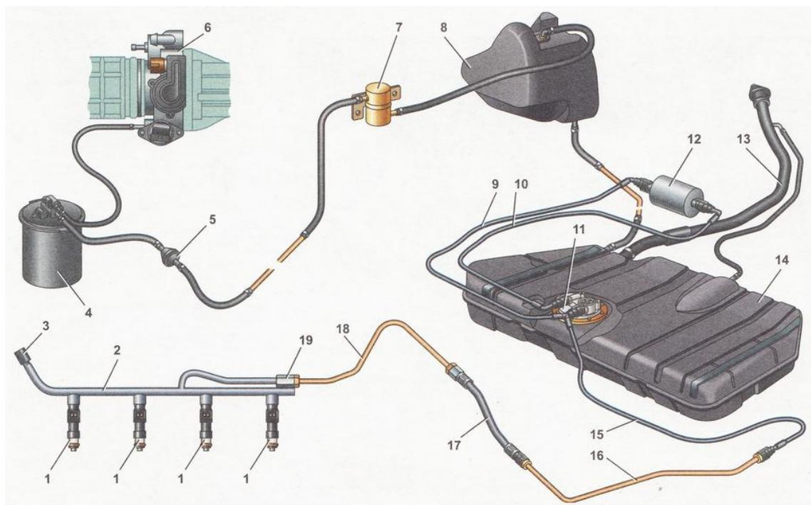
3. Диагностический штуцер измерения давления.
