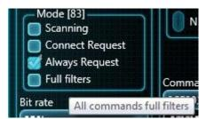
Появилась возможность полностью фильтровать команду (получаемый адрес). При включении опции «Full filters» будут включены фильтры всех команд, и полученные ответы от каждой команды/запроса будет строго фильтроваться. Это особенно актуально при отключенной опции «Always Request», когда приходит информация от
