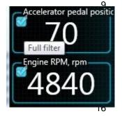
ожидаемой команды, но для другого адресата, и которую необходимо игнорировать во избежание получения неправильных данных. Также существует возможность включения и выключения фильтра для каждой команды индивидуально. При отключении опции «Full filters» будут выключены фильтры всех команд. При включении или выключении фильтров нажимать кнопку конфигурации «Set» не нужно, данные о фильтрах передаются в устройство ТЕ-Z9 автоматически, сразу после изменения состояний этих опций.
